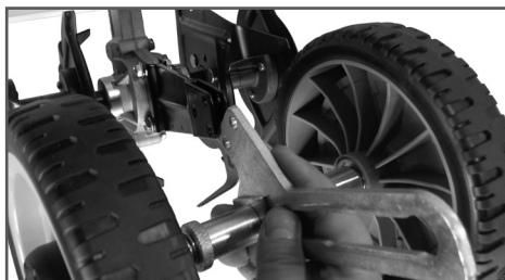
Рис. 6 Установка кронштейна колес
