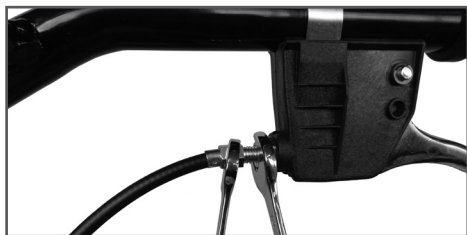
Рис. 10 Фиксация троса газа
